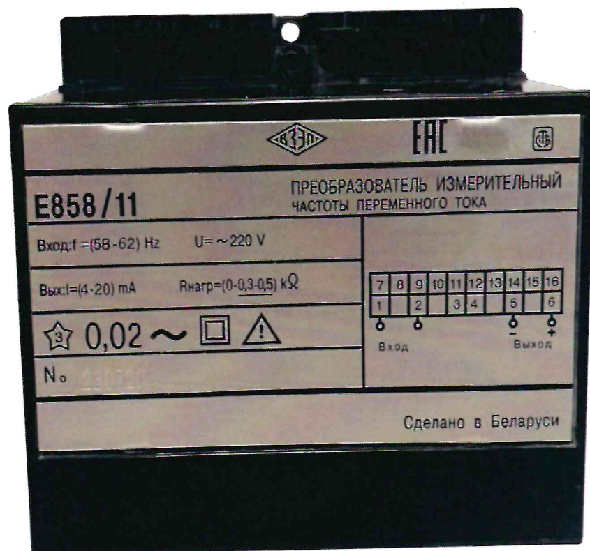
Рисунок 11 – Общий вид и маркировка ИП E858/11 для нужд народного хозяйства
