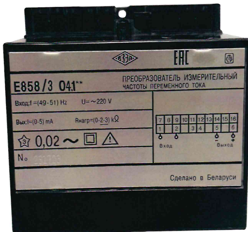
Рисунок 4 – Общий вид и маркировка ИП E858/3 04.1** для поставки на экспорт в общеклиматическом исполнении 04.1**
