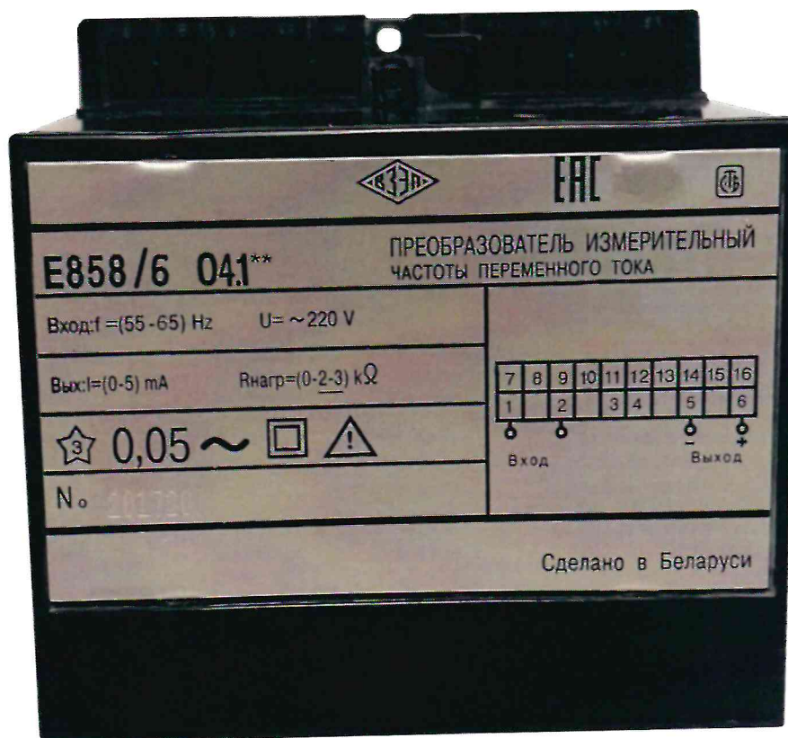
Рисунок 6 – Общий вид и маркировка ИП E858/6 04.1** для поставки на экспорт в общеклиматическом исполнении 04.1**
