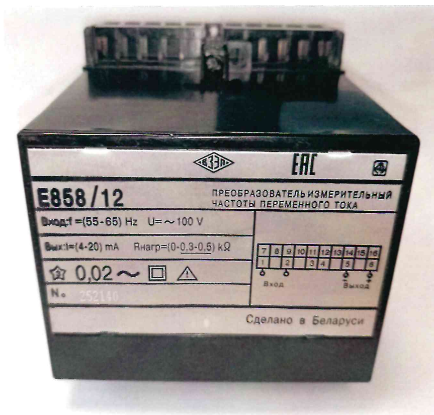
Рисунок 12 – Общий вид и маркировка ИП E858/12 для нужд народного хозяйства
