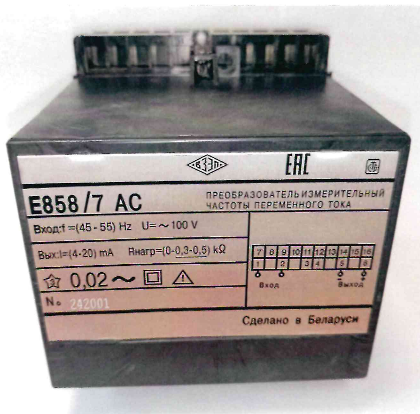
Рисунок 7 – Общий вид и маркировка ИП Е858/7 АС для поставки на атомные станции
