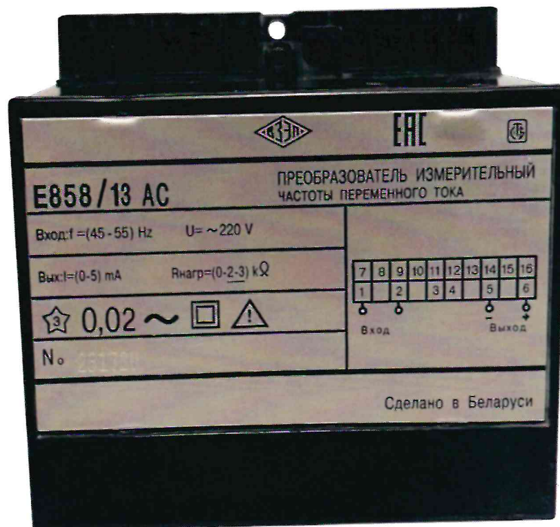
Рисунок 13 – Общий вид и маркировка ИП E858/13 AC для поставки на атомные станции
