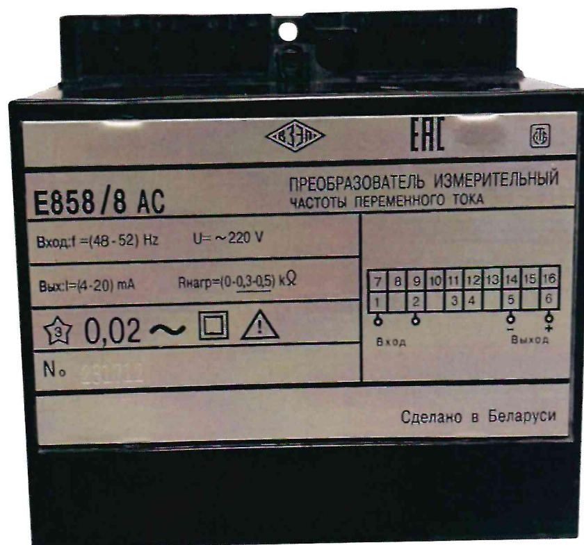
Рисунок 8 – Общий вид и маркировка ИП Е858/8 АС для поставки на атомные станции
