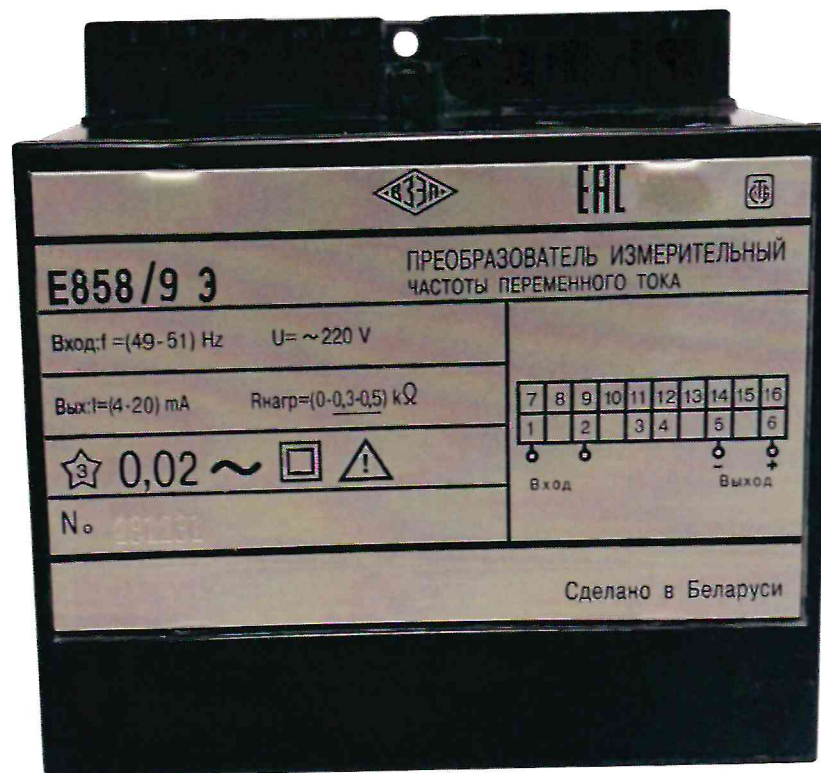
Рисунок 9 – Общий вид и маркировка ИП E858/9 Э для поставки на экспорт в страны с умеренным климатом
