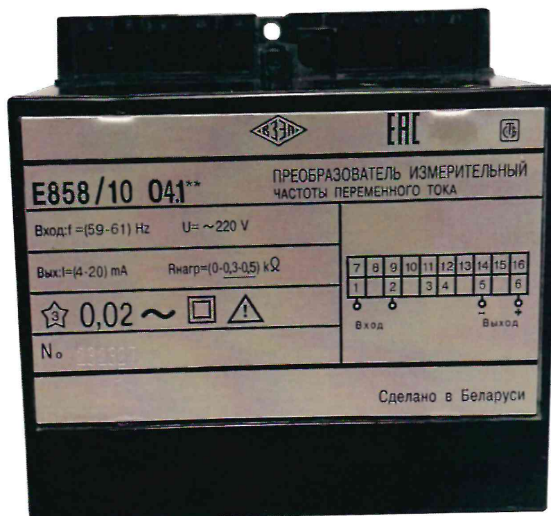
Рисунок 10 – Общий вид и маркировка ИП E858/10 O4.1** для поставки на экспорт в общеклиматическом исполнении O4.1**
