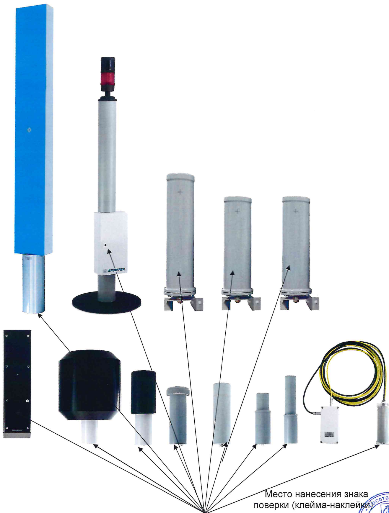
Рисунок 2 – Схема с указанием места нанесения знака поверки (клейма-наклейки)
