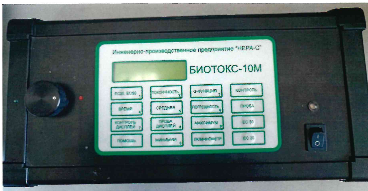
Рисунок 1.1 – Фотографии общего вида прибора экологического контроля Биотокс-10М №219Х
