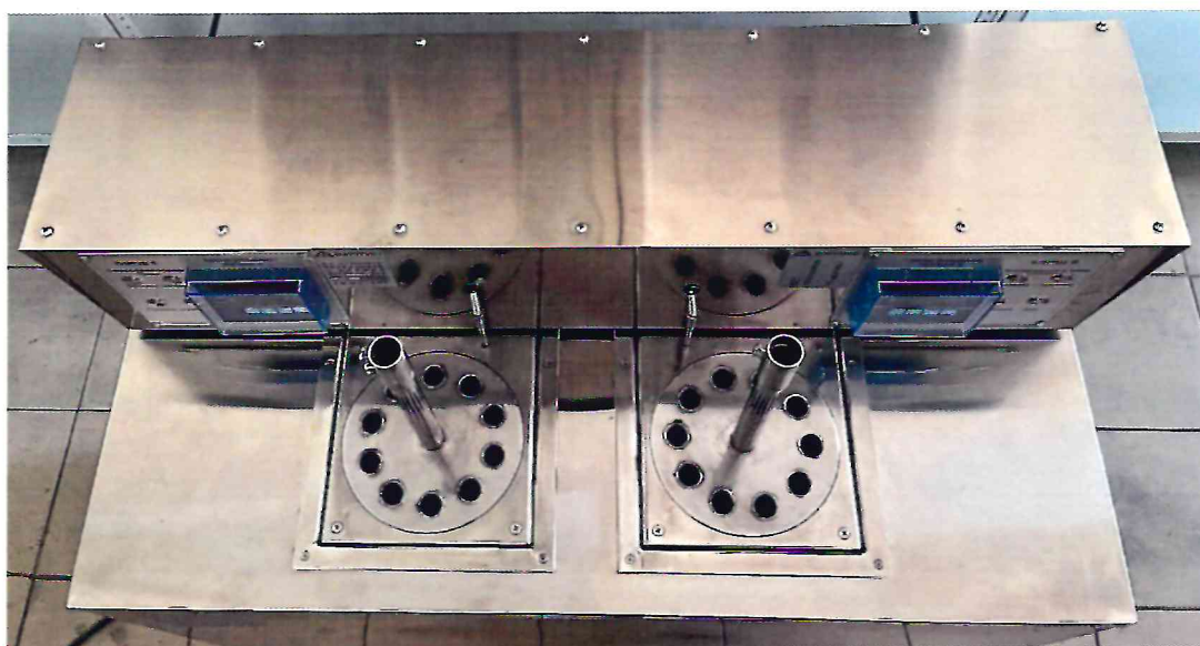
Рисунок 1.2 – Фотография термостата жидкостного RTS-0411 № 20240514-328 (вид сверху)
