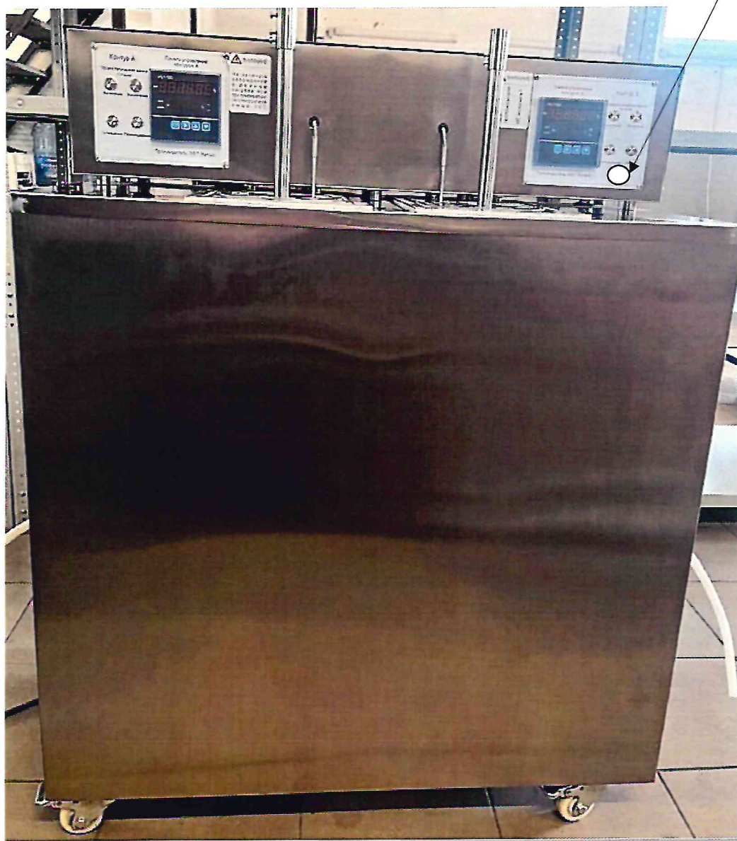
Рисунок 2.1 – Место нанесения знака поверки термостата жидкостного RTS-0411 № 20240514-328
