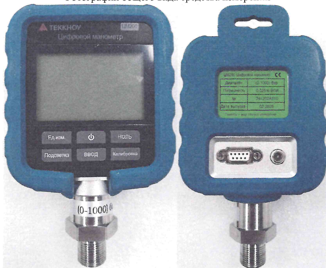
Рисунок 1.1 – Фотография общего вида. Цифровой манометр ЦМ200 № 241202A510
