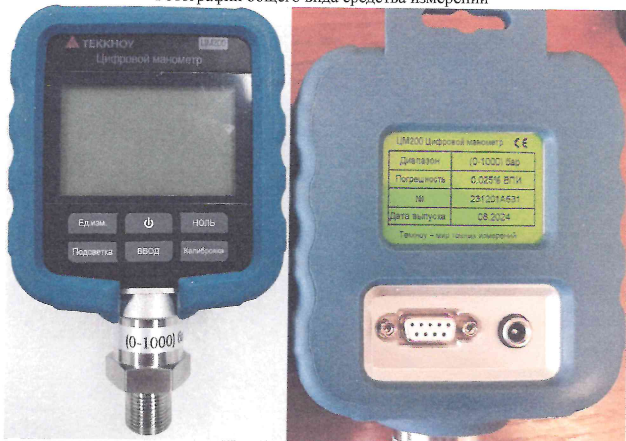
Рисунок 1.1 – Фотография общего вида. Цифровой манометр ЦМ200 № 231201A531
