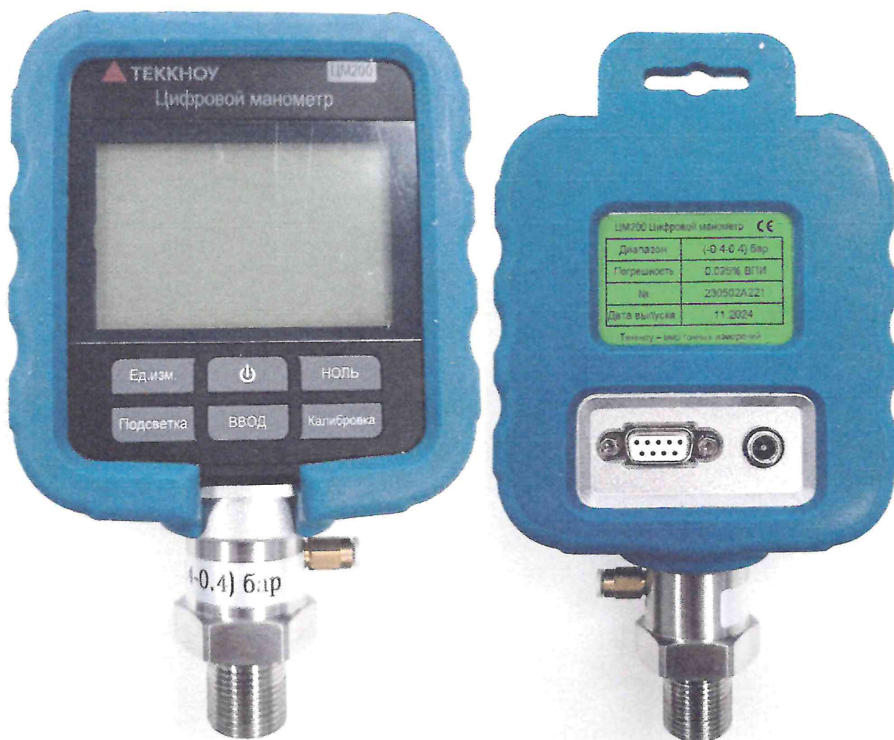
Рисунок 1.1 – Фотография общего вида. Цифрового манометра ЦМ200 № 230502A221
