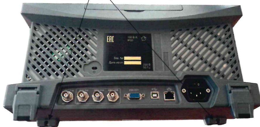
Рисунок 3.1 – Схема пломбировки от несанкционированного доступа
