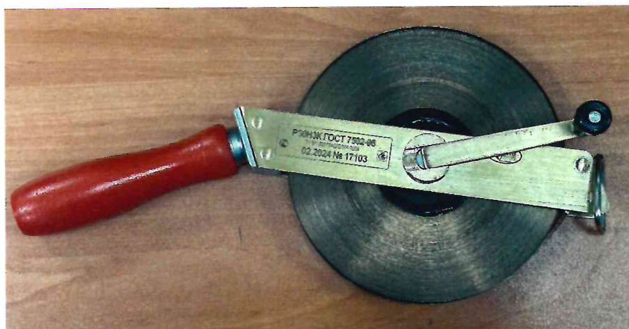
Рисунок 1.1 – Фотография общего вида рулетки измерительной металлической РНГ модификации по ГОСТ 7502-98 (изображение носит иллюстративный характер)
