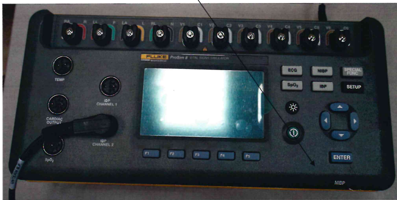
Рисунок 2.1 – Схема (рисунок) с указанием места для нанесения знака поверки на генератора сигналов пациента Fluke ProSim 8 № 6705052
