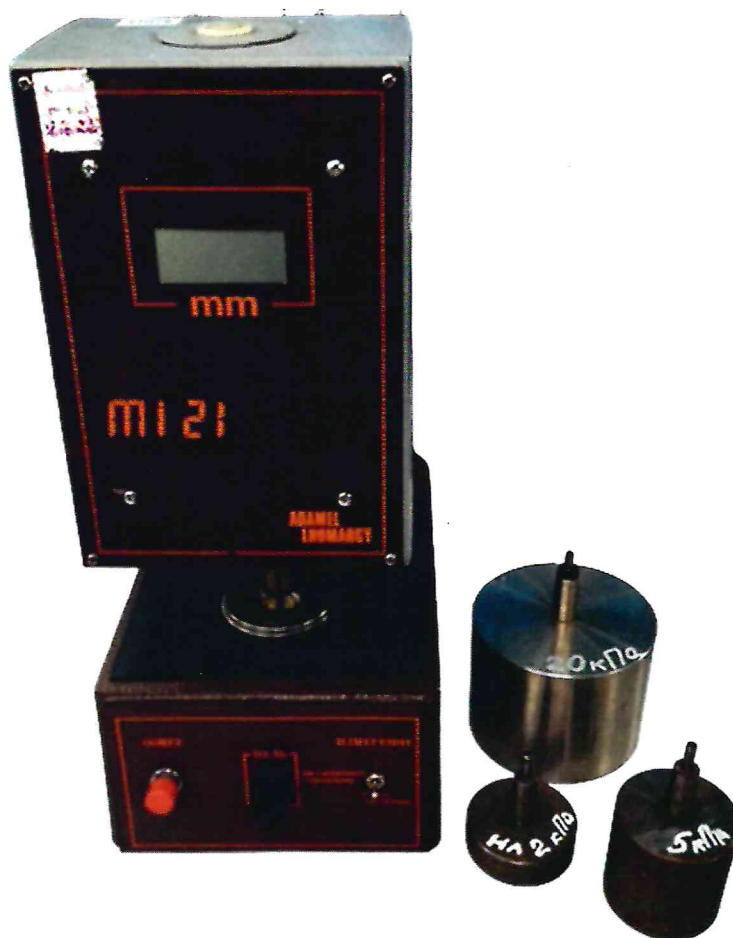
Рисунок 1.1 – Фотографии общего вида микрометра с цифровой индикацией ADAMEL LHOMARGY MI 21 № 409
