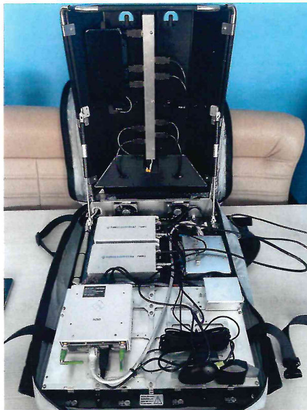
Рисунок 1.1 – Фотографии общего вида носимого измерительного комплекса для анализа параметров качества обслуживания сетей связи R&S Freerider 4 № 101194/101706
