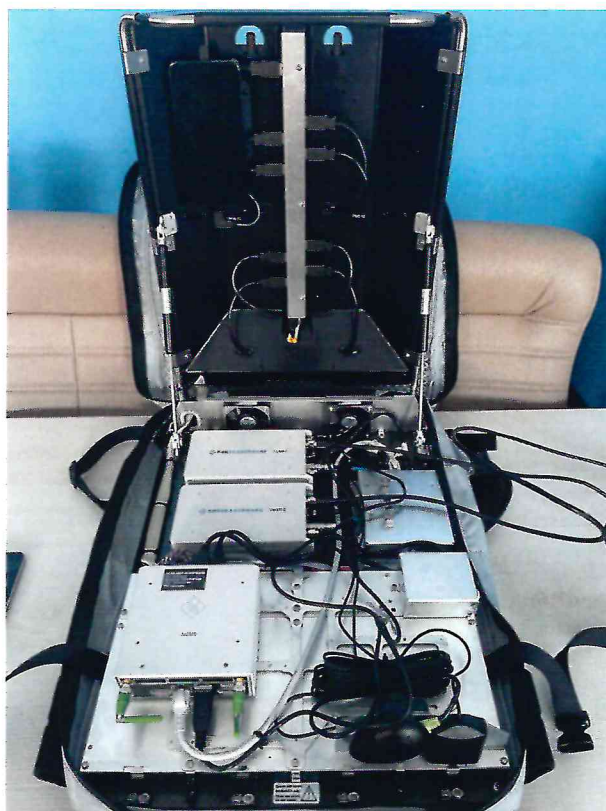
Рисунок 1.1 – Фотографии общего вида носимого измерительного комплекса для анализа параметров качества обслуживания сетей связи R&S Freerider 4 № 101177/101705
