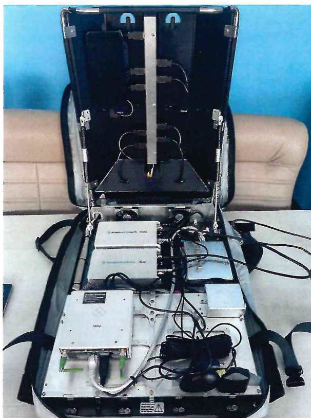
Рисунок 1.1 – Фотографии общего вида носимого измерительного комплекса для анализа параметров качества обслуживания сетей связи R&S Freerider 4 № 101176/101704
