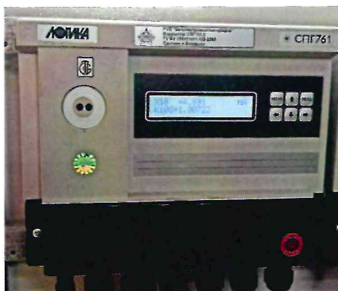
Рисунок 3 – Фотография корректора СПГ761.2
