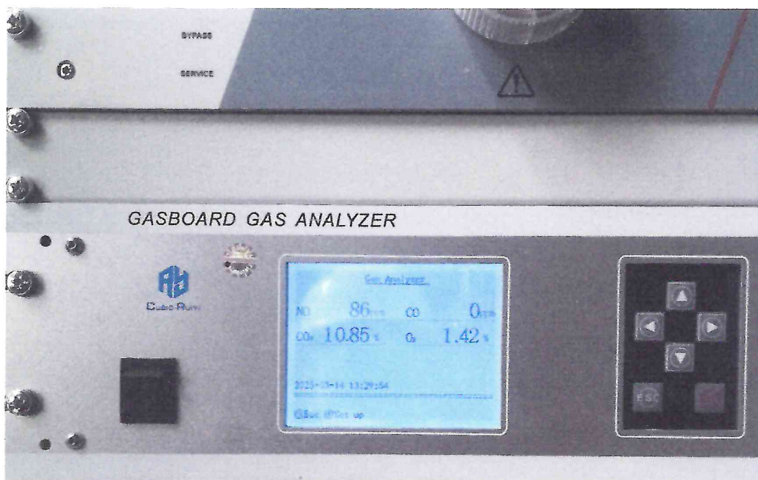
Рисунок 1.5 – Фотография газоанализатора. Система автоматизированная контроля выбросов № ECS-22.426-01
