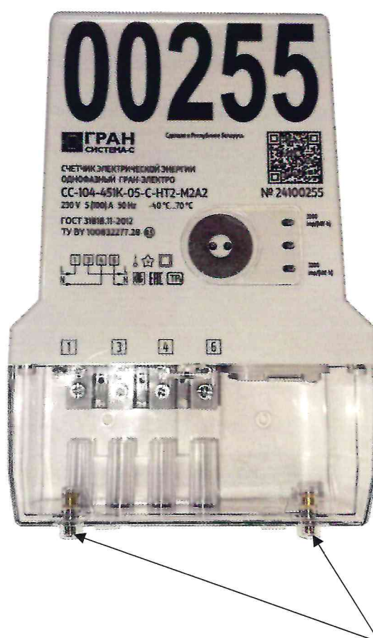
Рисунок 3.1 – Места пломбировки от несанкционированного доступа счетчиков электрической энергии однофазных «Гран-Электро» CC-104
