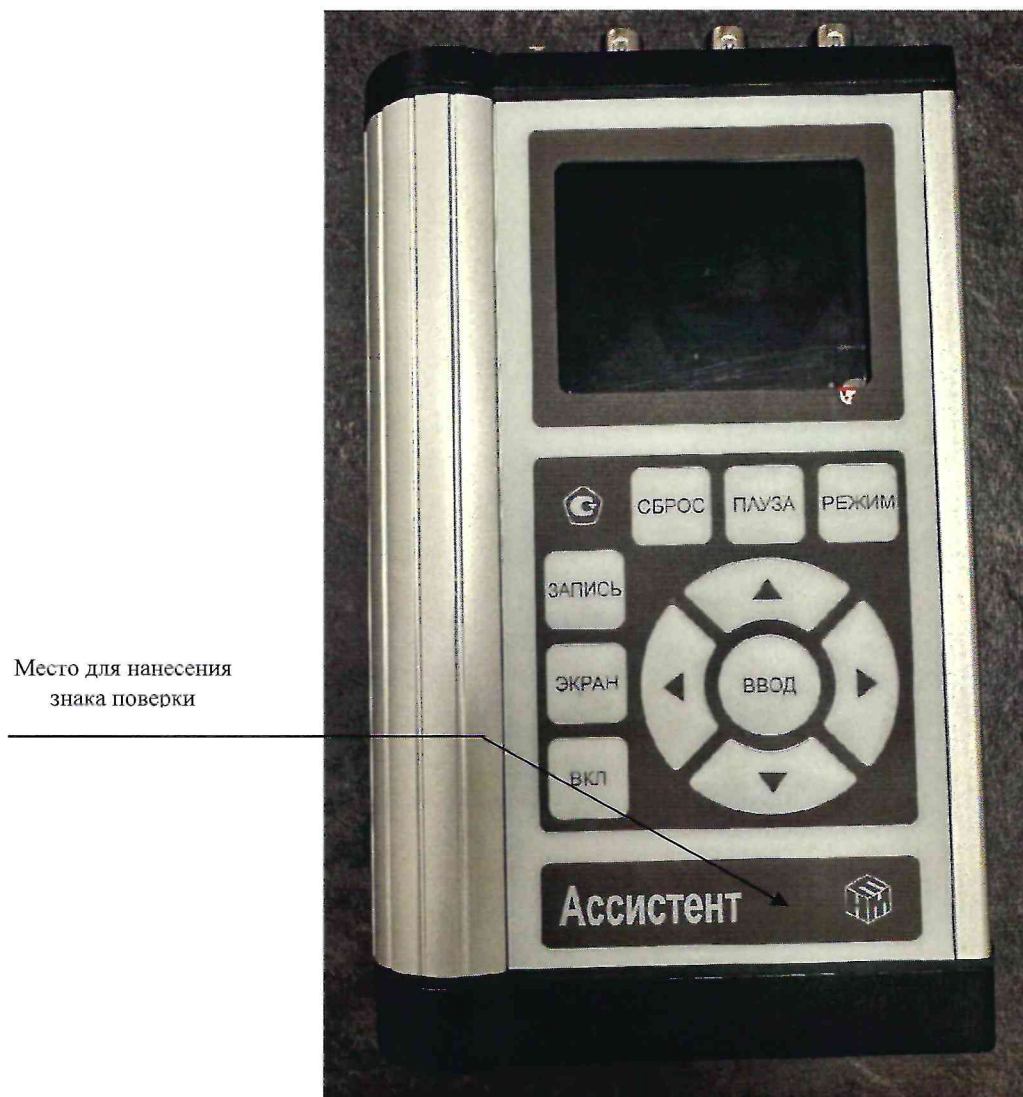
Рисунок 2.1 – Схема (рисунок) с указанием места для нанесения знака поверки
