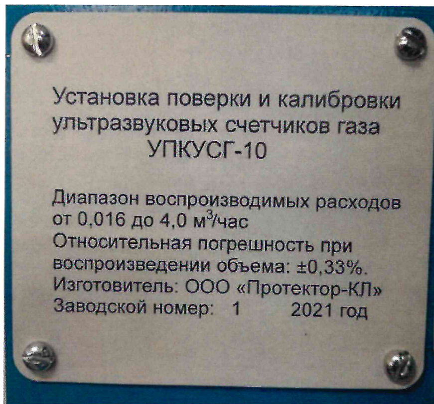
Рисунок 1.2 – Фотография маркировки установки поверки и калибровки ультразвуковых счетчиков газа УПКУСГ-10 № 1
