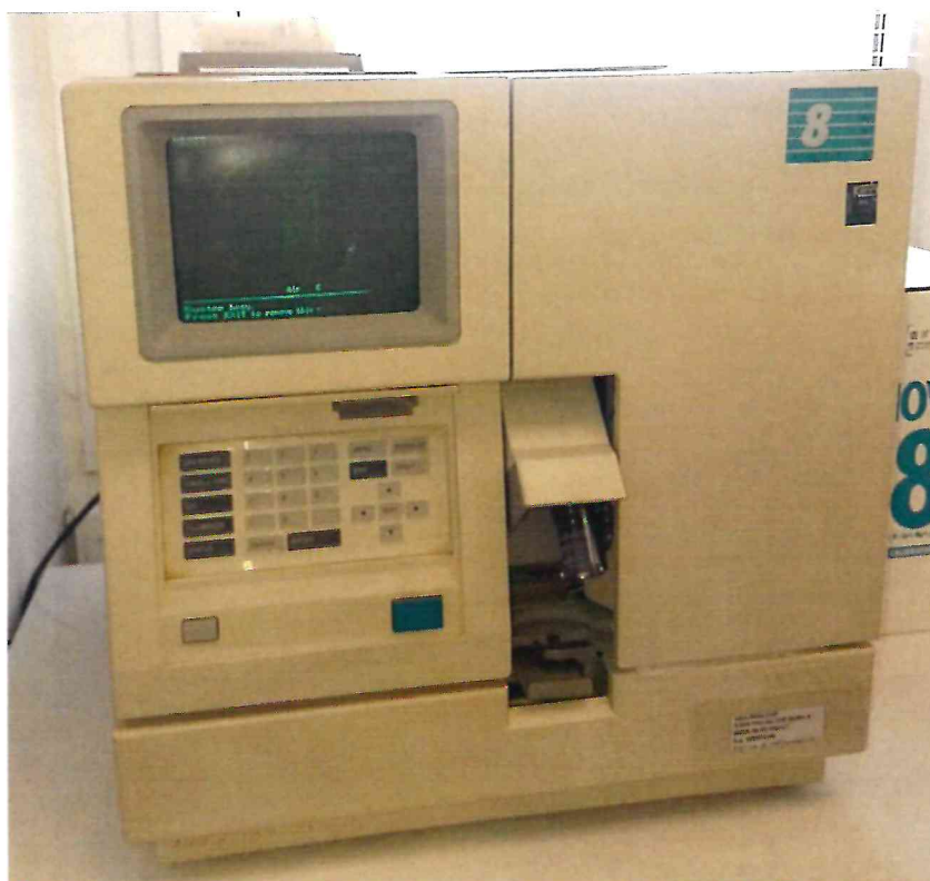
Рисунок 1.1 – Фотография общего вида анализатора электролитов автоматического NOVA 8 № N08903160
