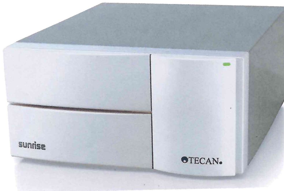
Рисунок 1.1 – Фотографии общего вида фотометра микропланшетного Sunrise
