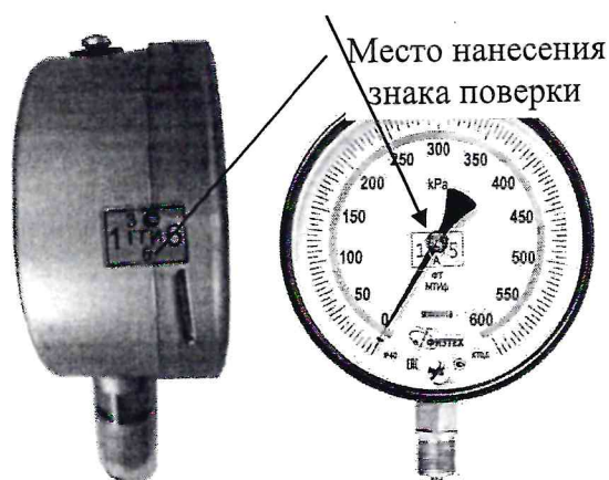
Рисунок 12 – Место нанесения знака поверки
