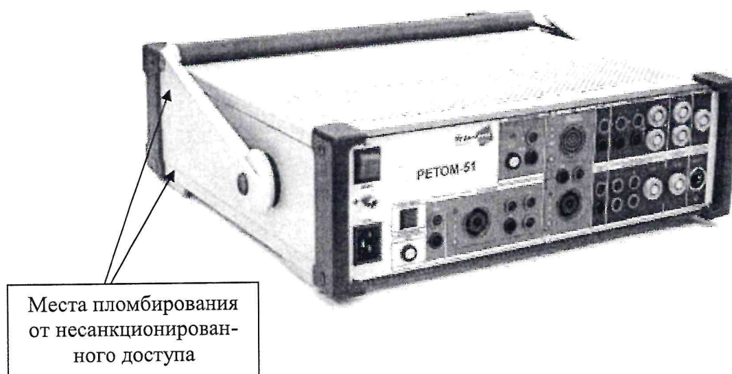
Рисунок 1 – Общий вид устройства РЕТОМ ™ -51 и места пломбирования от несанкционированного доступа
