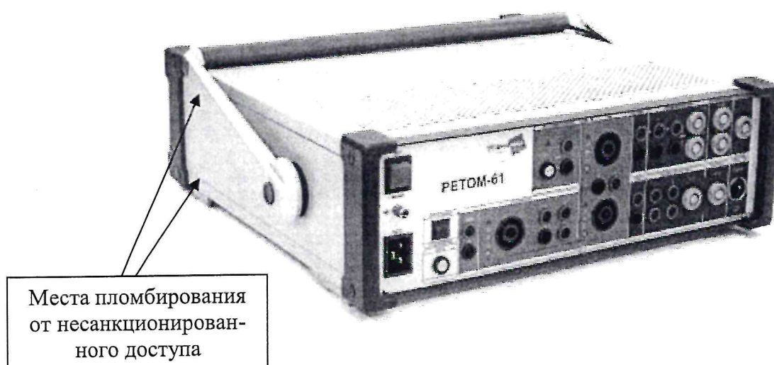
Рисунок 3 – Общий вид устройства РЕТОМ™-61 и места пломбирования от несанкционированного доступа
