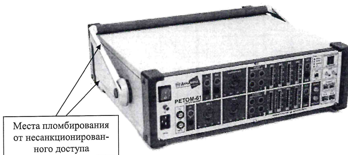
Рисунок 3 – Общий вид устройства РЕТОМ™-61 и места пломбирования от несанкционированного доступа
