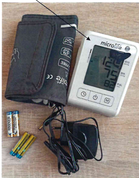
Рисунок 2.18 – Схема (рисунок) с указанием места для нанесения знака поверки на прибор для измерения артериального давления BP B2 Standard
