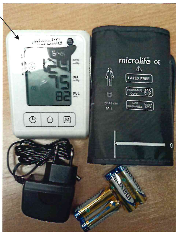
Рисунок 2.15 – Схема (рисунок) с указанием места для нанесения знака поверки на прибор для измерения артериального давления BP B1 Classic
