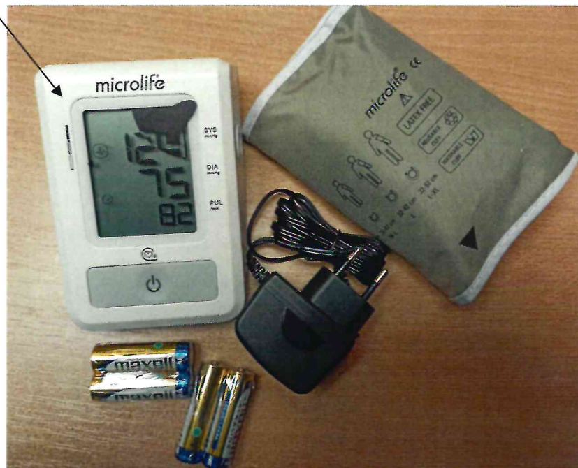
Рисунок 2.11 – Схема (рисунок) с указанием места для нанесения знака поверки на прибор для измерения артериального давления BP B2 Easy
