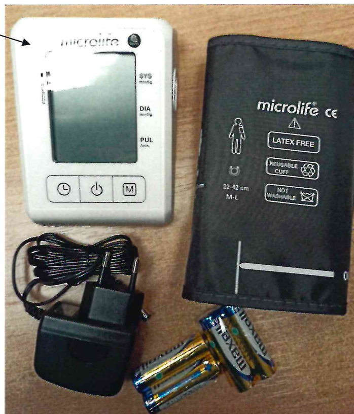
Рисунок 2.12 – Схема (рисунок) с указанием места для нанесения знака поверки на прибор для измерения артериального давления BP B2 Basic
