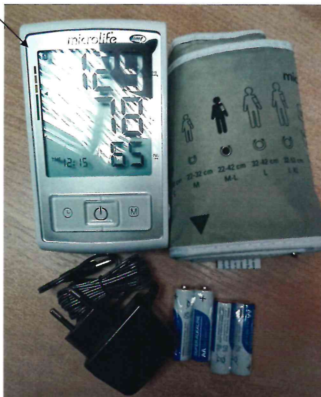
Рисунок 2.7 – Схема (рисунок) с указанием места для нанесения знака поверки на прибор для измерения артериального давления BP A3L Comfort
