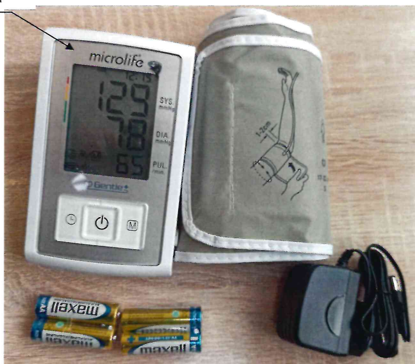
Рисунок 2.6 – Схема (рисунок) с указанием места для нанесения знака поверки на прибор для измерения артериального давления BP A3 Plus
