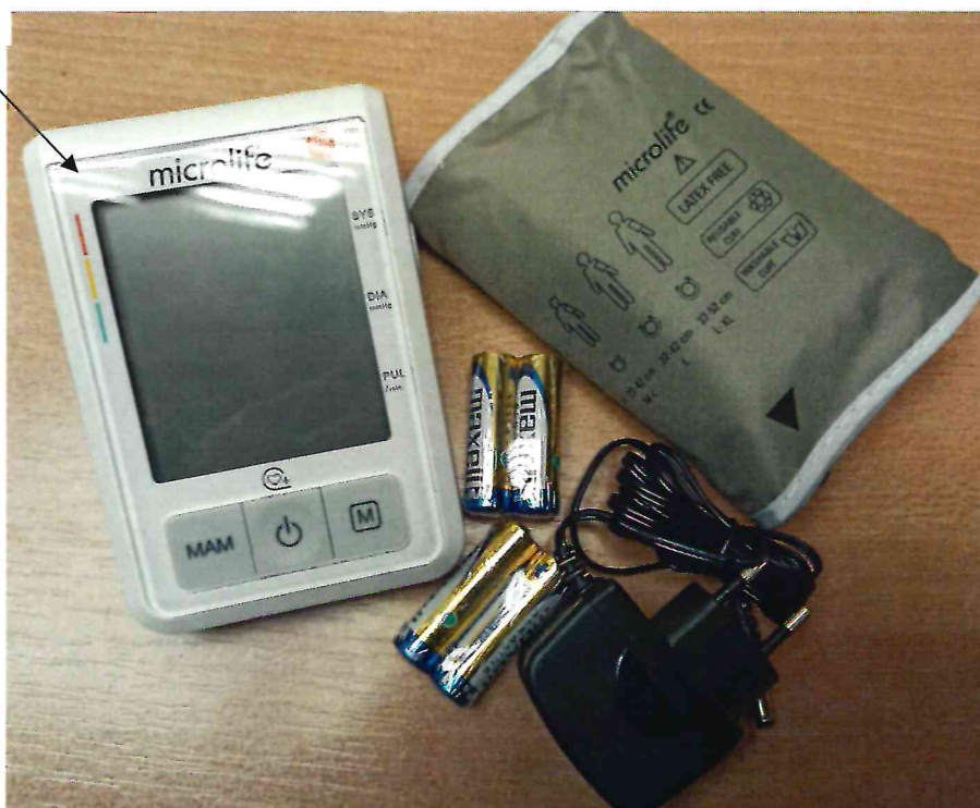
Рисунок 2.14 – Схема (рисунок) с указанием места для нанесения знака поверки на прибор для измерения артериального давления BP B3 Basic
