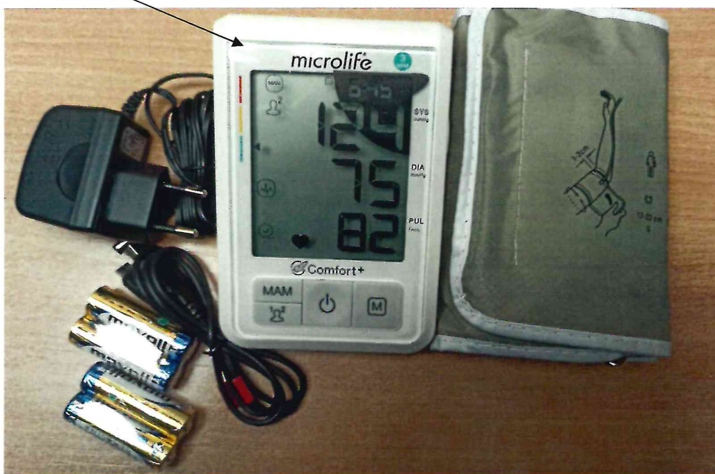
Рисунок 2.13 – Схема (рисунок) с указанием места для нанесения знака поверки на прибор для измерения артериального давления BP B3 Comfort PC
