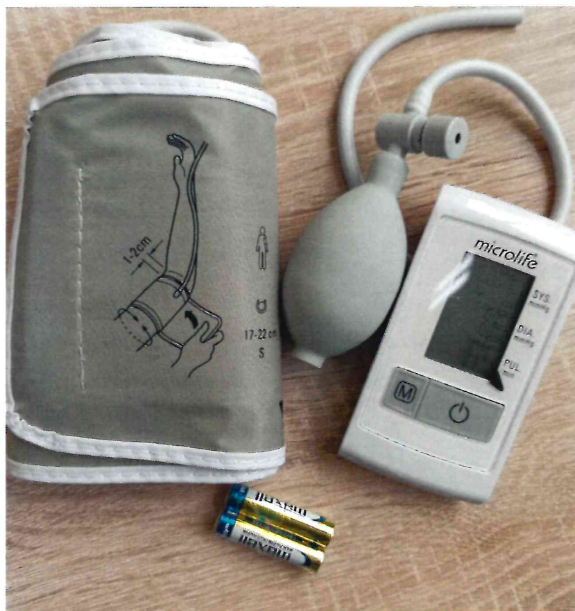
Рисунок 1.3 – Фотография общего вида прибора для измерения артериального давления BP A50 (изображение носит иллюстративный характер)
