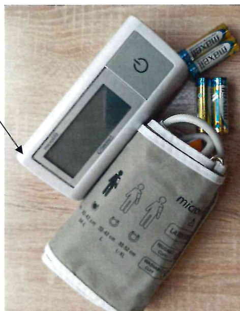
Рисунок 2.2 – Схема (рисунок) с указанием места для нанесения знака поверки на прибор для измерения артериального давления ВР А90
