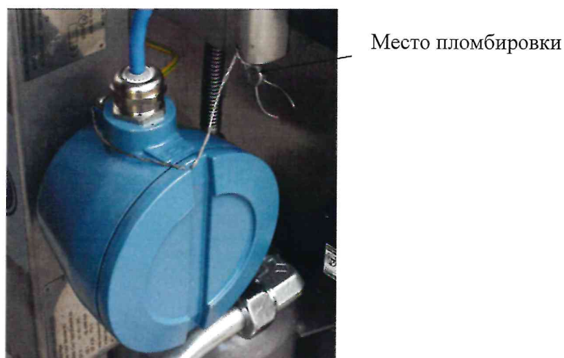
Рисунок 3.15 – Схема пломбировки от несанкционированного доступа магнитных датчиков импульсов ME 01-05, ME 01-05-05, MTX 075, ADAST 40
