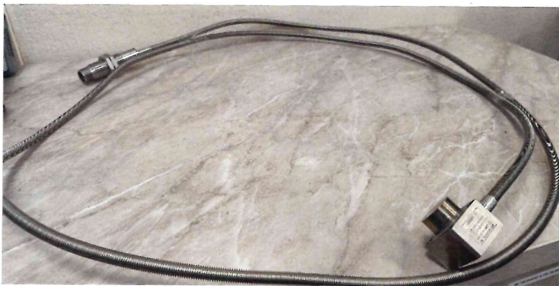
Рисунок 1.1 – Фотография общего вида виброизмерительного преобразователя PZENT-18E03401 № 23/188801
