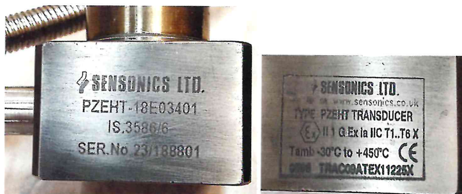
Рисунок 1.1 – Фотография общего вида виброизмерительного преобразователя PZENT-18E03401 № 23/188801
