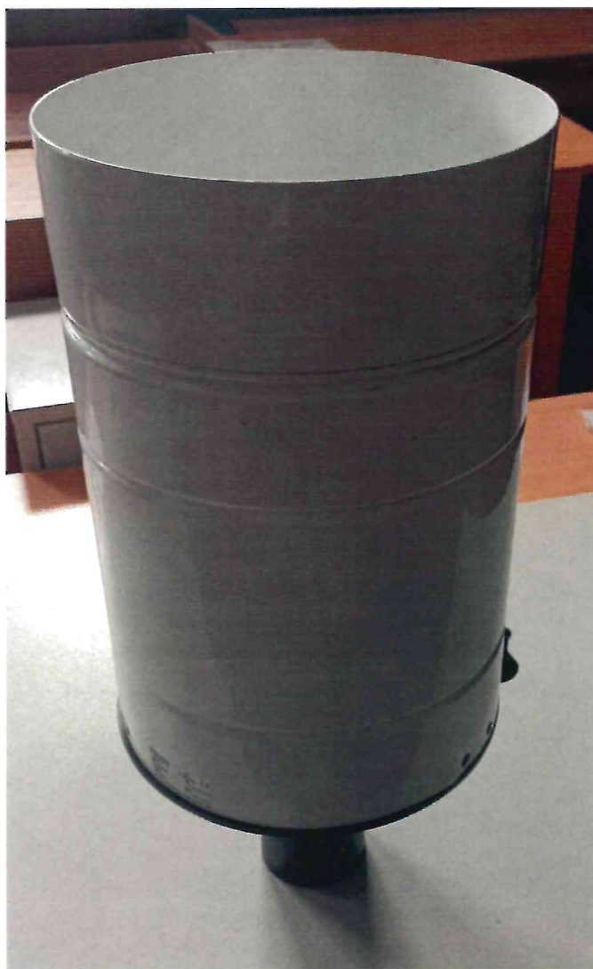
Рисунок 1.1 – Общий вид датчика осадков PL400R-N № 1013268
