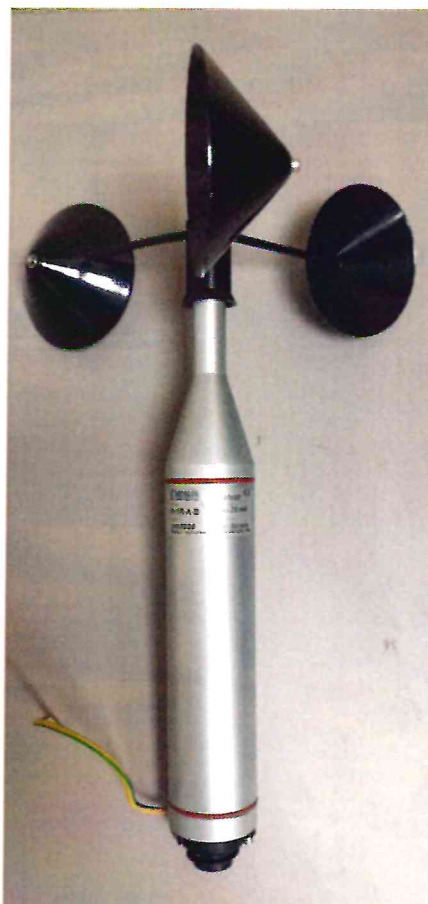
Рисунок 1.1 – Фотография общего вида датчика скорости ветра VV1R № 1013226
