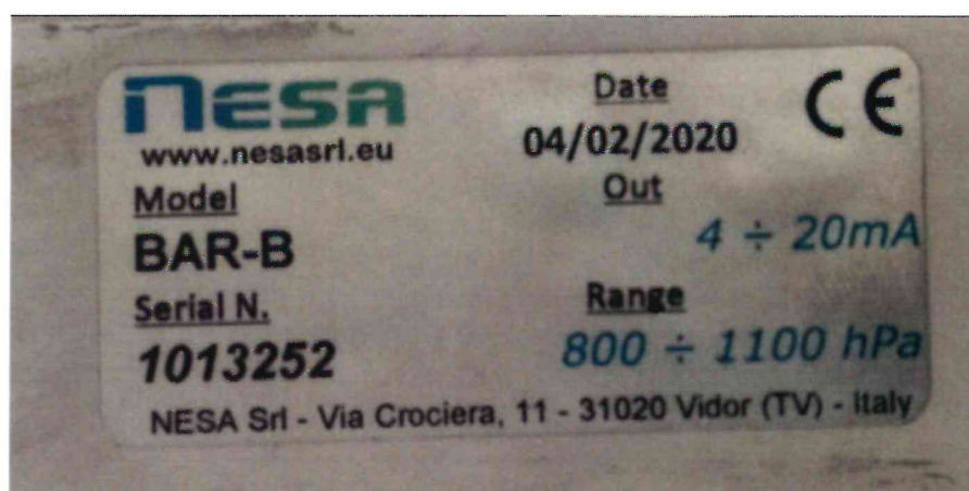
Рисунок 1.2 – Фотография маркировки атмосферного давления BAR-B № 1013252
