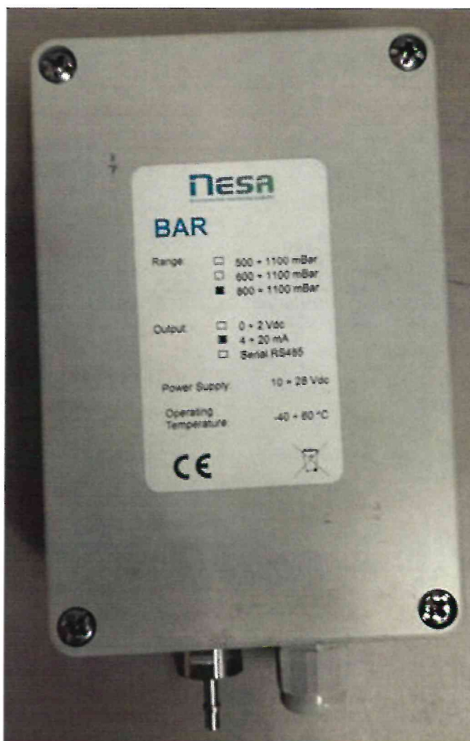
Рисунок 1.1 – Фотография общего вида датчика атмосферного давления BAR-B № 1013252
