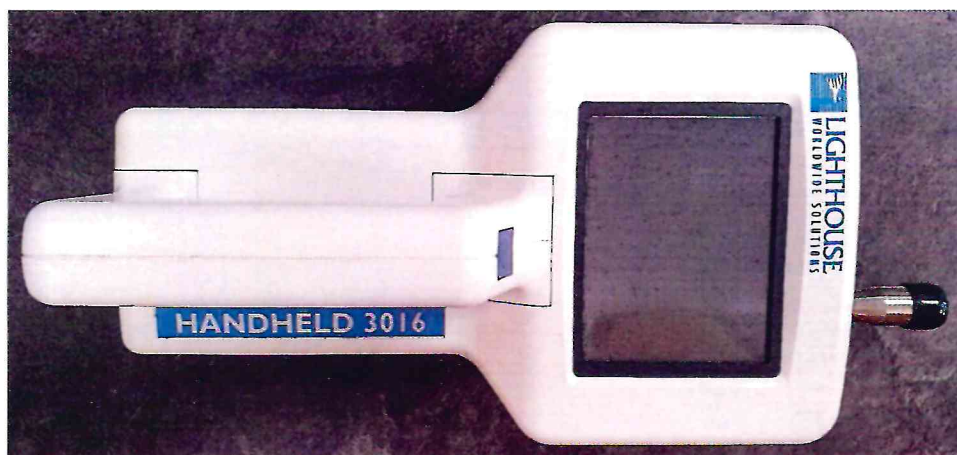
Рисунок 1.1 – Общий вид счетчика аэрозольных частиц Lighthouse Handheld 3016 № 190802004
