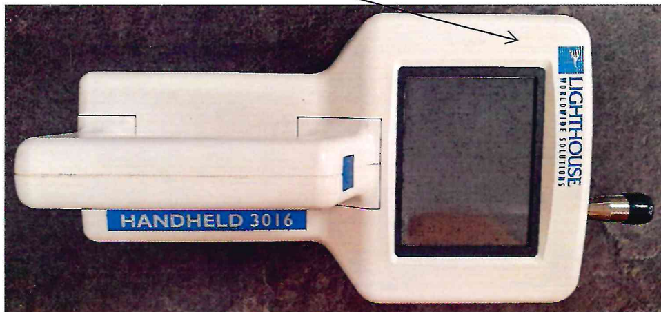
Рисунок 2.1 – Схема (рисунок) с указанием места для нанесения знака поверки средств измерений
