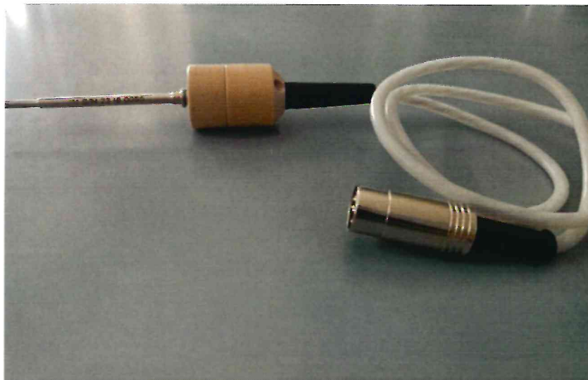
Рисунок 1.1 – Фотография общего вида термопреобразователя сопротивления ISL №23 I8 0055
