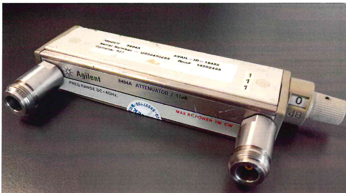
Рисунок 1.1 – Фотография общего вида аттенюатора Agilent 8494A № US00430263
