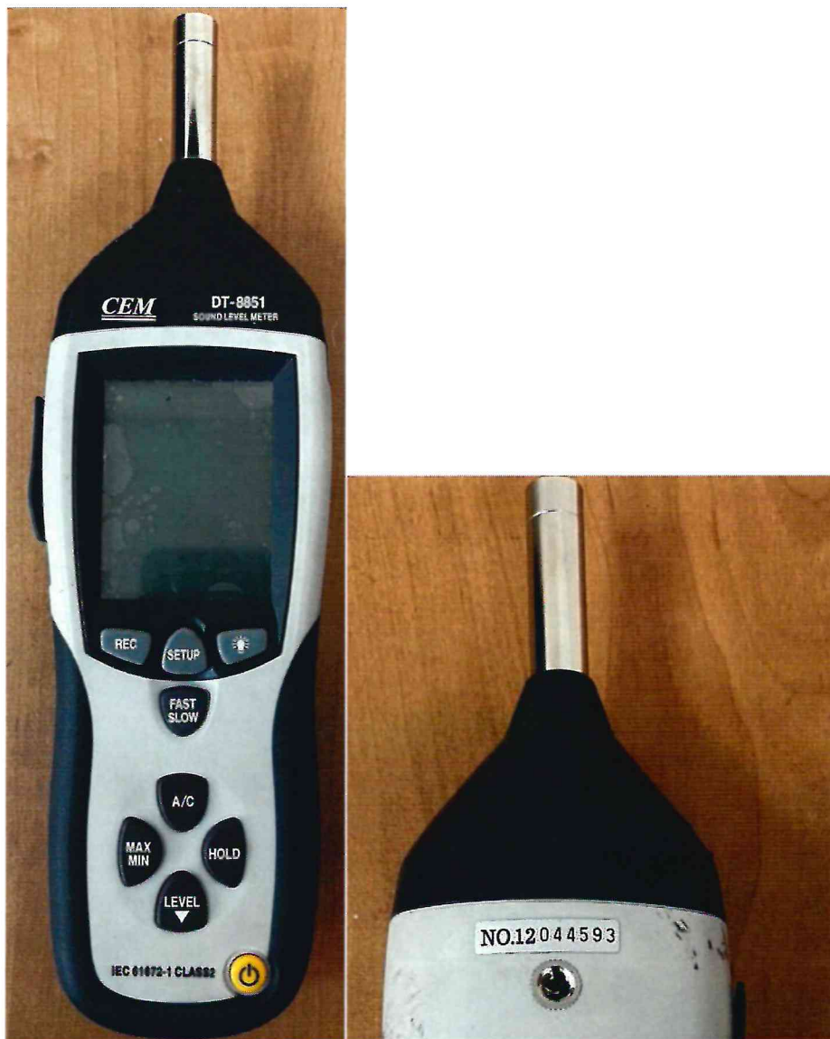
Рисунок 1.1 – Фотография общего вида измерителя уровня звука DT-8851 № 12044593
