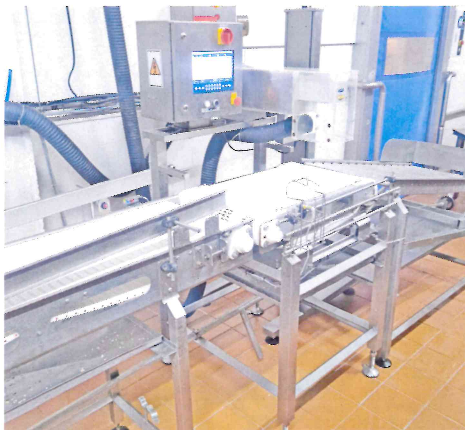
Рисунок 1.1 – Фотография общего вида системы динамического взвешивания DWT/RC30/HYF № 781387/23
