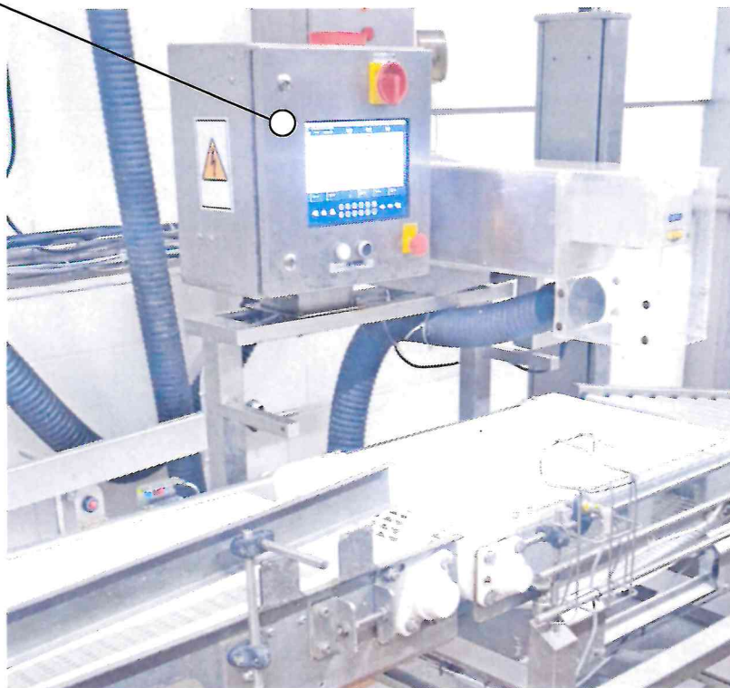
Рисунок 2.1 – Схема с указанием места для нанесения знака поверки системы динамического взвешивания DWT/RC30/HYF № 781387/23
