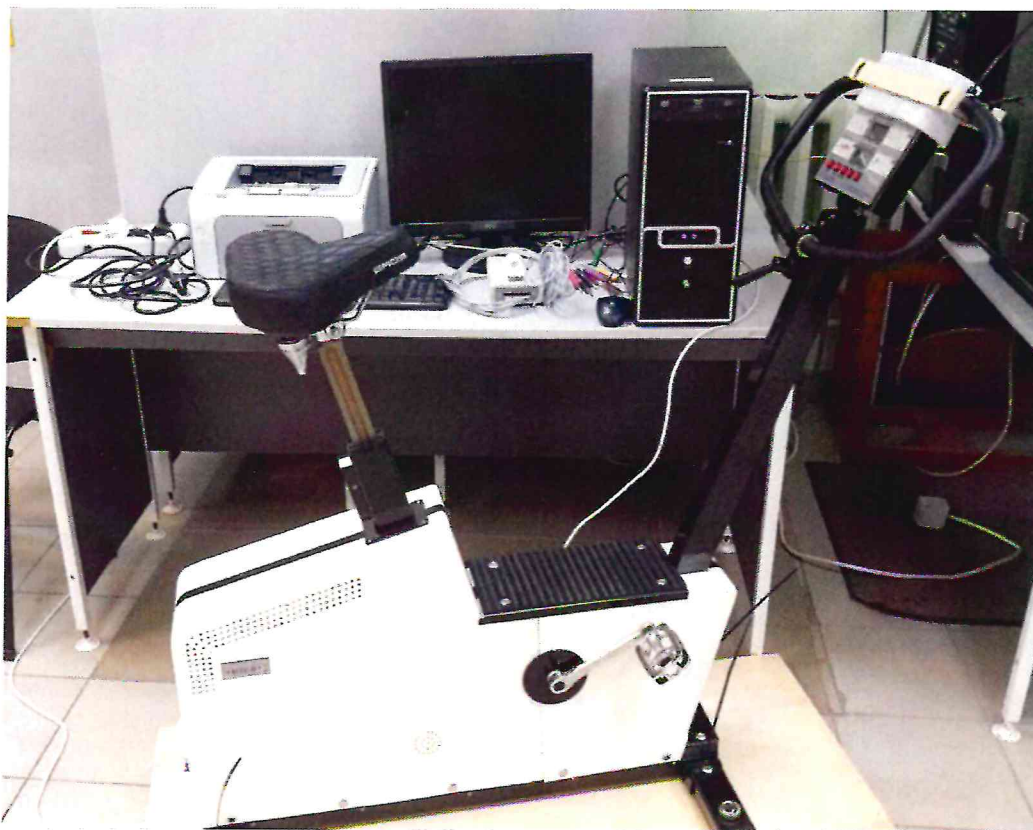
Рисунок 1.1– Фотография общего вида системы электрокардиоизмерительной для реабилитации и диагностики М32-К2 УНИСЕТ (изображение носит иллюстративный характер)
