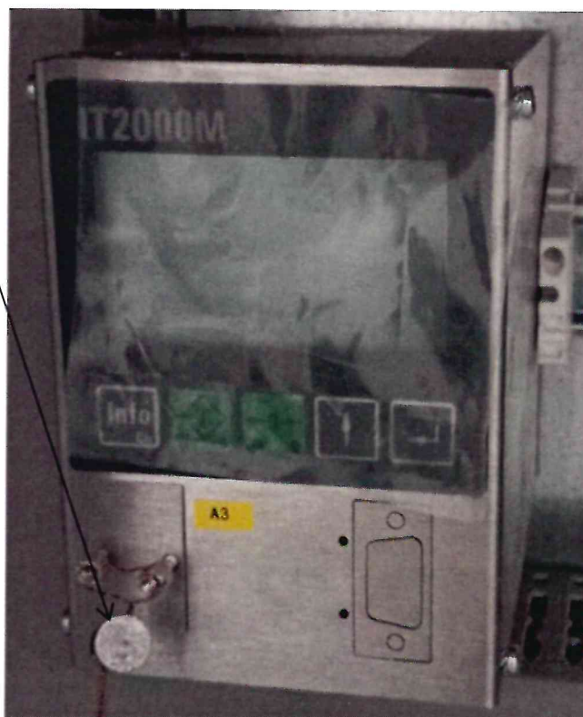
Рисунок 3.1 – Фотография с указанием места пломбировки от несанкционированного доступа в виде давления на пломбу на лицевой стороне терминала весового IT2000M
