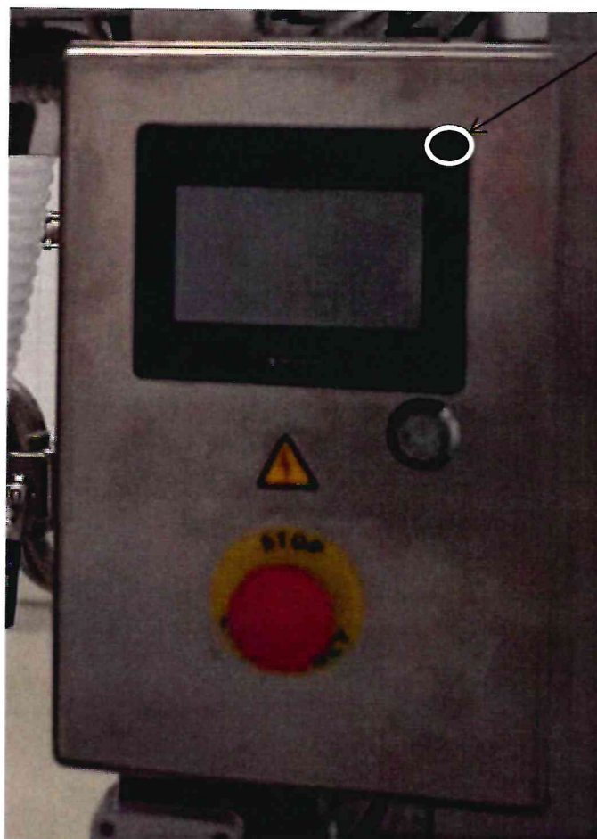
Рисунок 2.1 – Фотография с указанием места нанесения знака поверки (наклейки) на лицевую сторону панели оператора сенсорной Weintek MT8052iP
