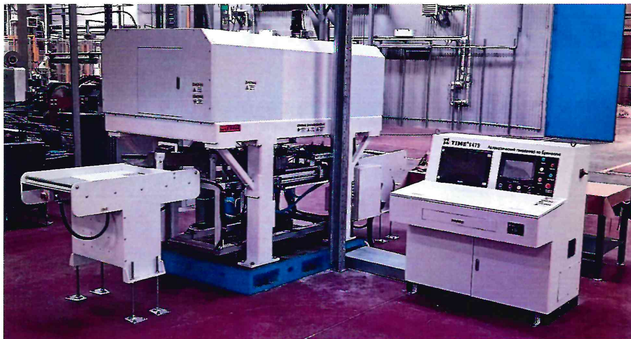
Рисунок 1.1 – Фотография общего вида твердомера автоматического по Бринеллю TIME6479B2 № 037
