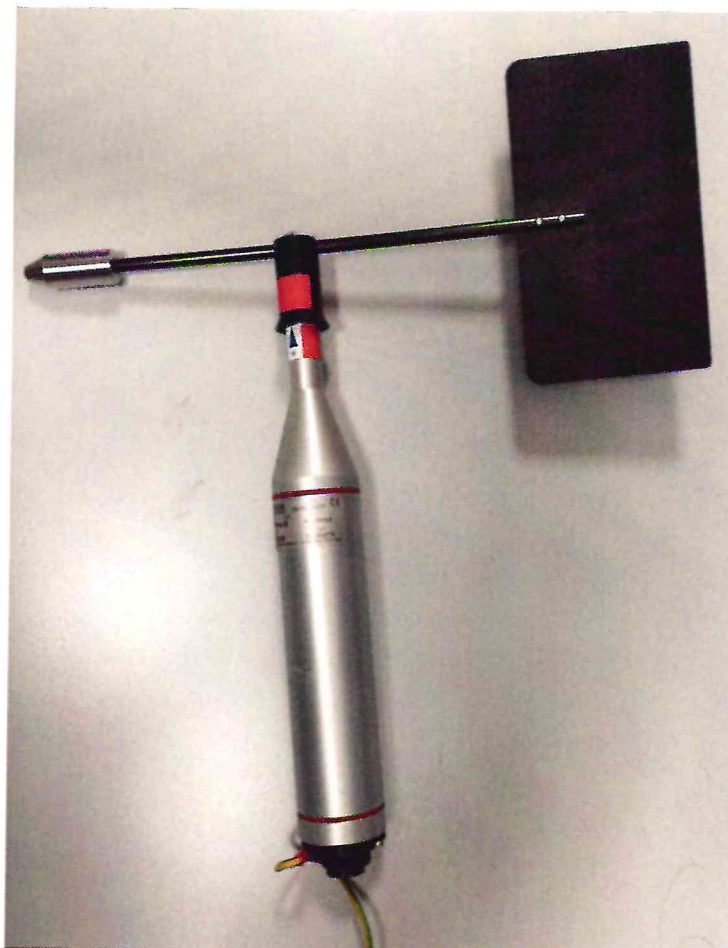
Рисунок 1.1 – Фотография общего вида датчика направления ветра DVER-A-B № 1013229
