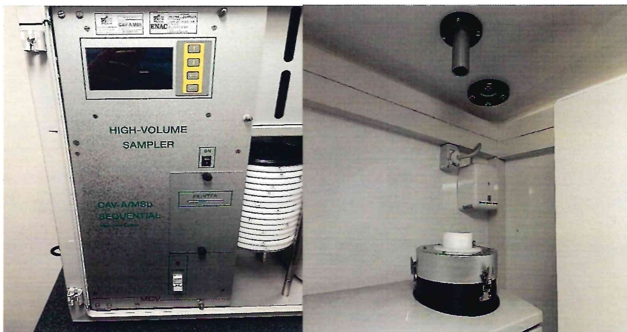
Рисунок 1.1 – Фотографии общего вида высокочастотного пробоотборника твердых частиц CAV-A/MSb № В-135/1258
