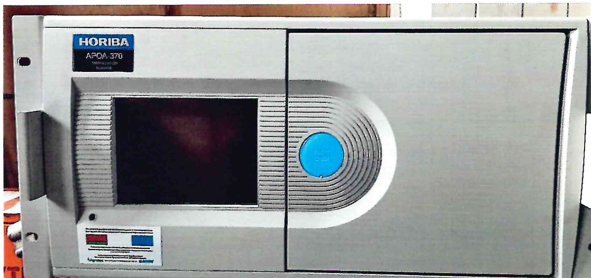
Рисунок 1.1 – Фотография общего вида анализатора озона APOA-370 № 904668
