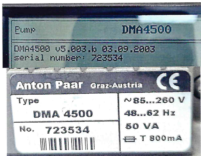
Рисунок 1.2 – Фотография маркировки плотномера DMA 4500 № 723534
