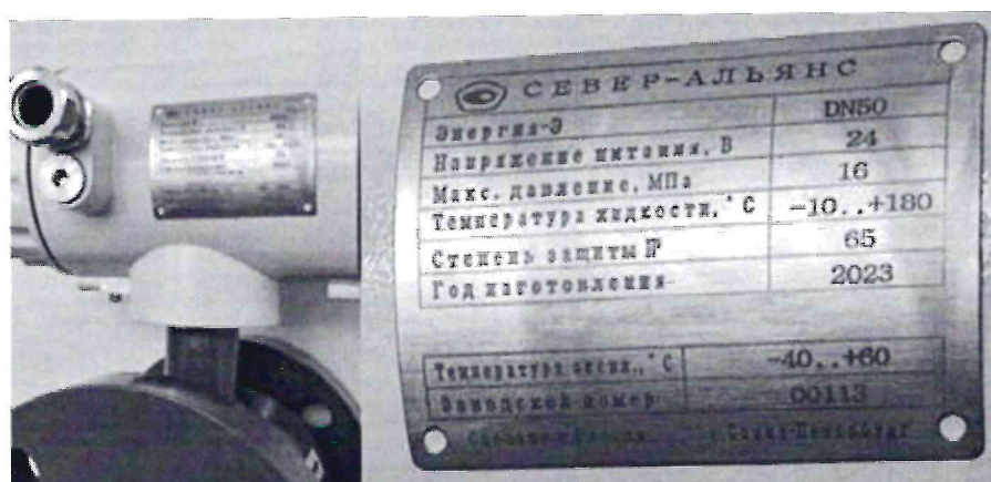
Рисунок 3 – Место нанесения знака утверждения типа (пример общего вида) маркировочной таблички)
