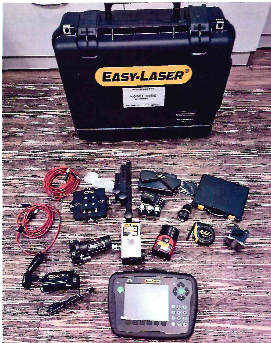
Рисунок 1.1 – Фотография общего вида системы выверки отверстий Easy-Laser E950C № 00000024
