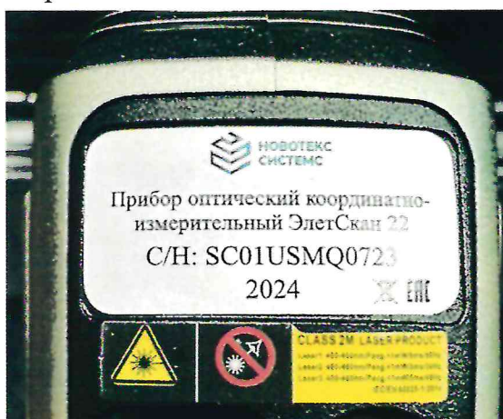
Рисунок 1.2 – Маркировка прибора оптического координатно-измерительного ЭлетСкан 22 № SC01USMQ0723
