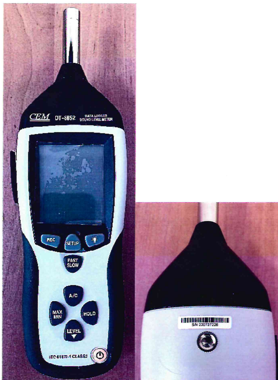
Рисунок 1.1 – Фотография общего вида измерителя уровня звука DT-8852 № 230737226
