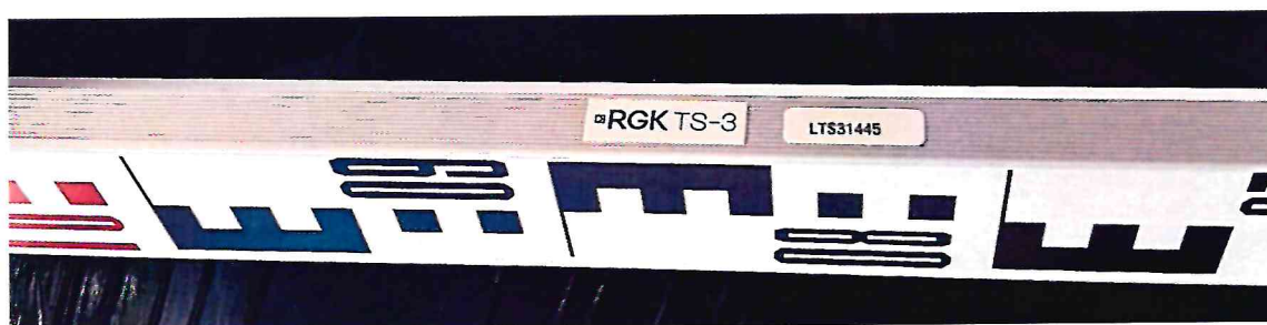
Рисунок 1.1 – Фотография общего вида реек нивелирных телескопических RGK (изображение носит иллюстративный характер)
