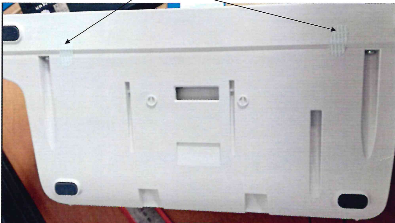
Рисунок 3.1 – Схема пломбировки от несанкционированного доступа мониторов пациента иМЕС (вид снизу)
