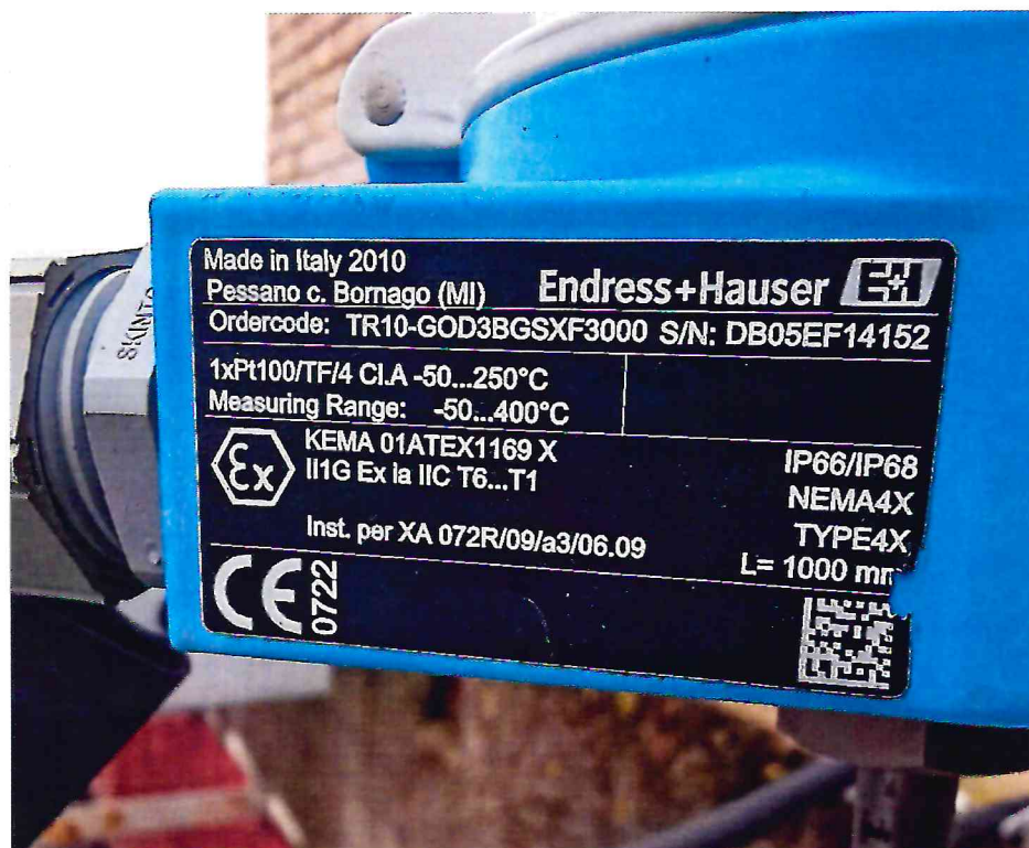
Рисунок 1.6 – Фотография маркировки термопреобразователя сопротивления TR10-GOD3BGSXF3000 входящего в состав узла учета поступающих сточных вод Минской очистной станции № Ц01
