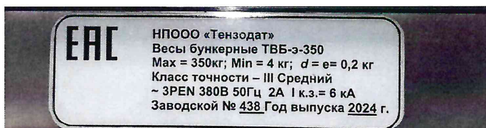
Рисунок 1.2 – Маркировка весов бункерных ТВБ-э-350 № 438
